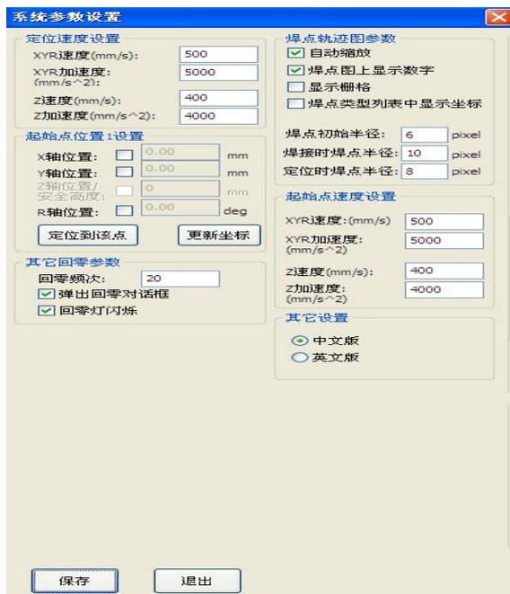
设置界面里管理员可以对定位速度、起始点位置、回零参数, 焊点轨迹参数、起始点速度及焊锡软件语言进行设置。
