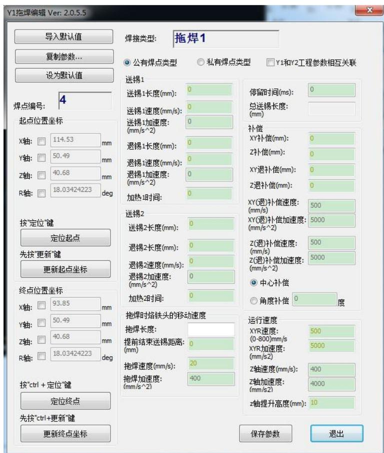
则弹出焊点的参数设置界面。然后通过操作无线键盘上的方向键，对剩余的其他点进行采点，该过程中可能会用到阵列等指令，可参照阵列指令操作说明。
