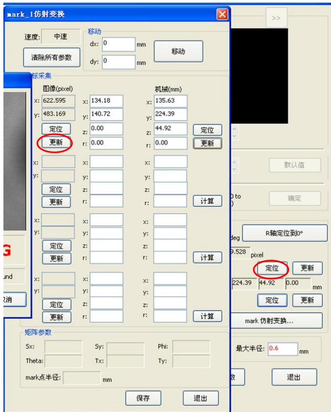
点击上图中的“图像位置”选框中的定位，让烙铁头移至 Mark\_1 位置，点击“Mark\_1 仿射变换”窗口中的“更新”，将当前机械坐标更新至 1 号点。
