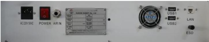
包含电源线插座、整机电源开关、气管接头、风扇、铭牌、USB 接口、静电接头、网线接口。
