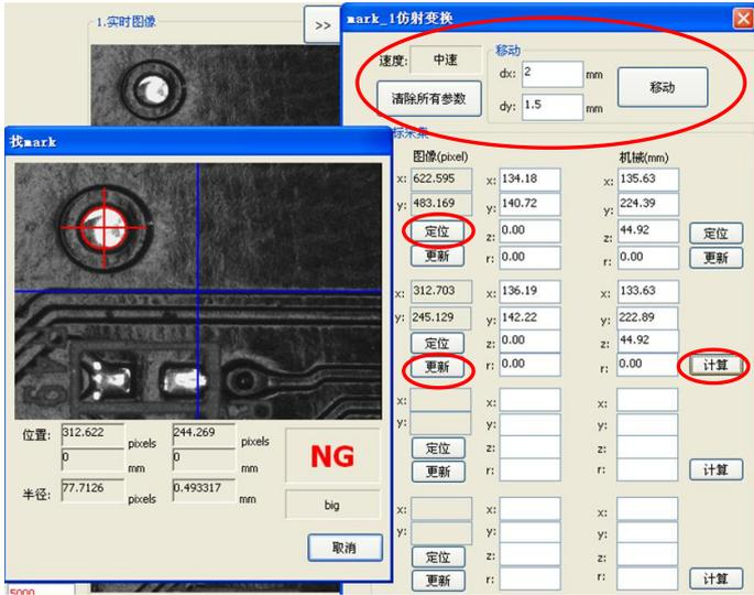
同理，点击在仿射变换窗口“坐标采集”数据框中的“点1”的“定位”，光标移至 Mark\_1 位置。上部“移动”数据框中，输入 x,y 位置的偏移值。建议选取“x=-2, y=1.5”，点击“移动”。在“点3”数据框中，点击“更新”和“计算”，将偏移数据更新至3号位置；
