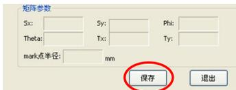
根据 Mark\_1 点的半径数据，设置“判断条件”，依次按“保存参数”和“退出”，保存 Mark\_1 点的拍照设置并退出。
