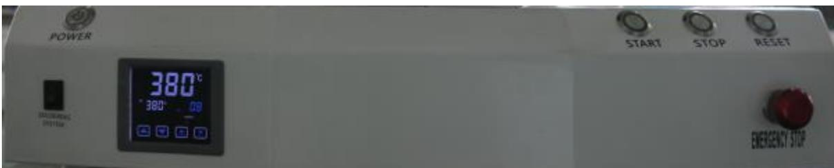
包含电脑开机、启动、停止、复位、急停按钮。温控的电源开关、升温、降温、设置。
