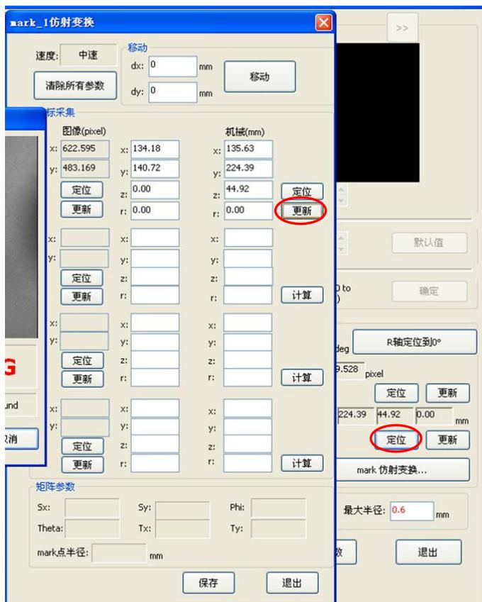
点击在仿射变换窗口“坐标采集”数据框中的“点1”的“定位”，光标移至 Mark\_1 位置。上部“移动”数据框中，输入 x,y 位置的偏移值。建议选取“x=2, y=1.5”，点击“移动”。在“点2”数据框中，点击“更新”和“计算”，将偏移数据更新至2号位置；
